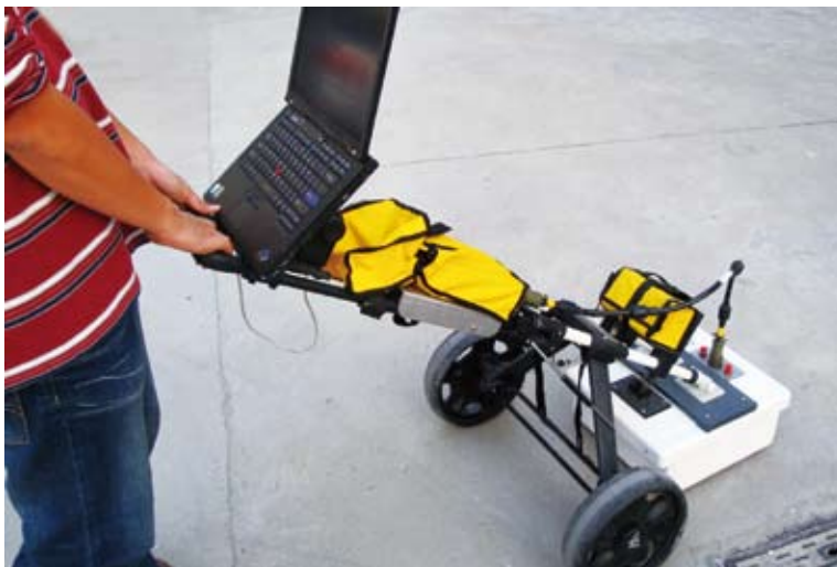
专门针对地下暗管排放的雷达探地仪(摄于2008年)
